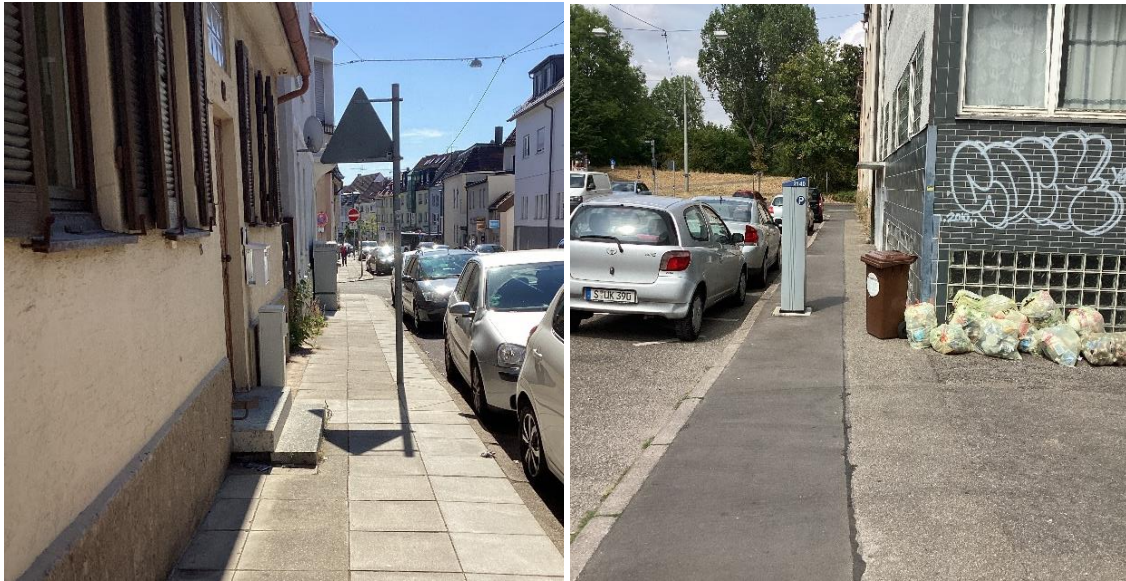
Abbildung 12: Eingeschränkte Gehwegbreite durch verschiedene Elemente (Treppeneingang, falsch positioniertes Schild, Stromkasten, Parkautomat, Mülltonnen)
