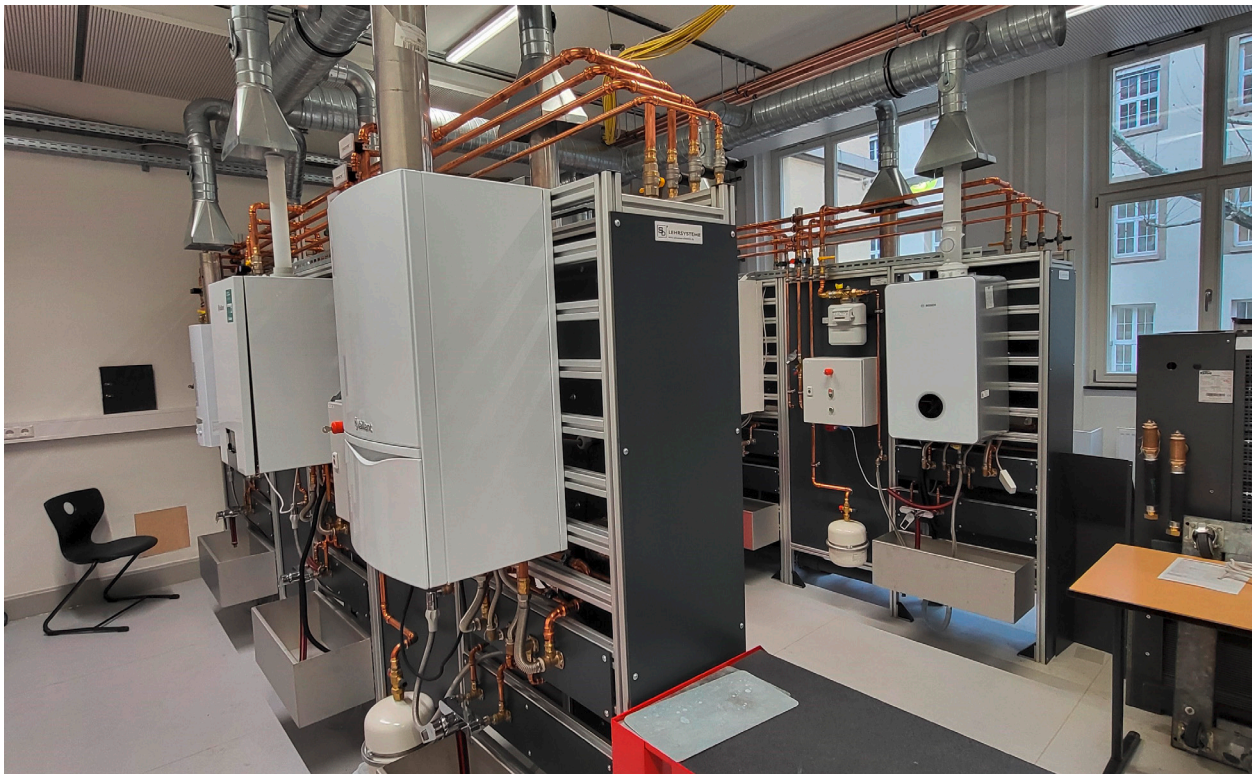
Blick auf die Versorgungsseite der Heizsysteme im Heizungsversuchsraum
