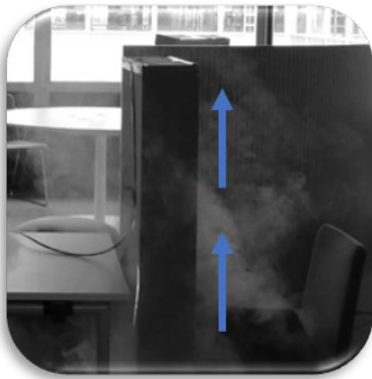
Bild 4-1: Thermischer Auftrieb an einem Dummy
