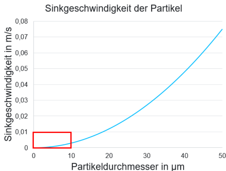
Bild 2-9: Sinkgeschwindigkeit bei verschiedenen Partikelgrößen
