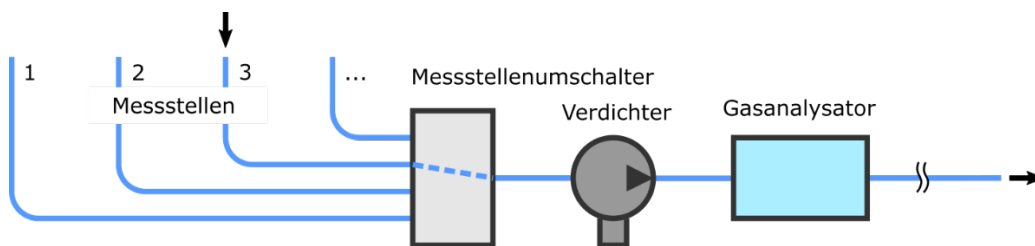
Bild 3-5: Schematisches Prinzip der Messstellenumschaltung
