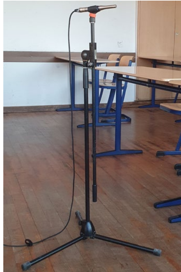
Bild 3-8: Beispiel einer Schallmessung in einem Klassenraum
